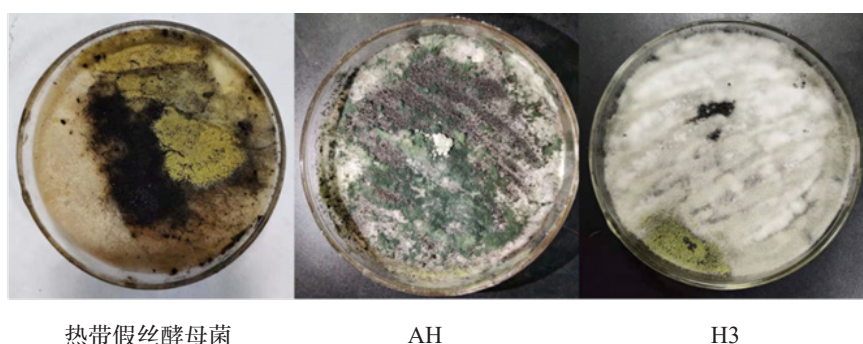
图 3 3 株实验室分离真菌的平板溶煤效果图
